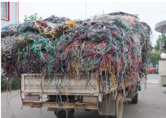
写真 1: 被覆銅線のリサイクル過程で出た絶縁体 (筆者撮影)
